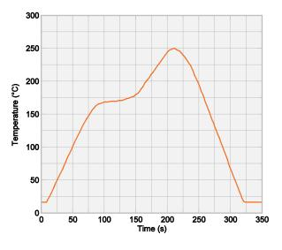
**RECOMMENDED REFLOW SOLDERING PROFILE**
